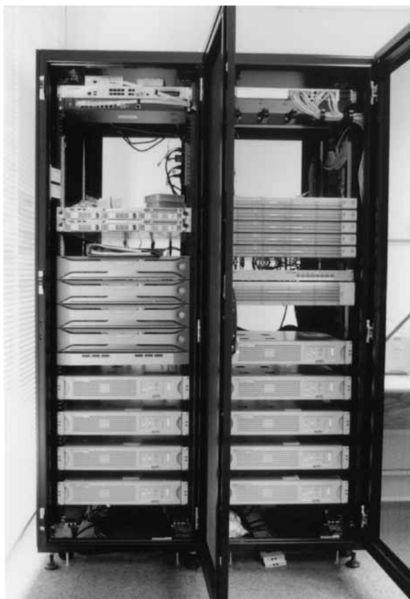
導入された HDD サーバーシステム 40 テラバイトの HDD + バッテリー
